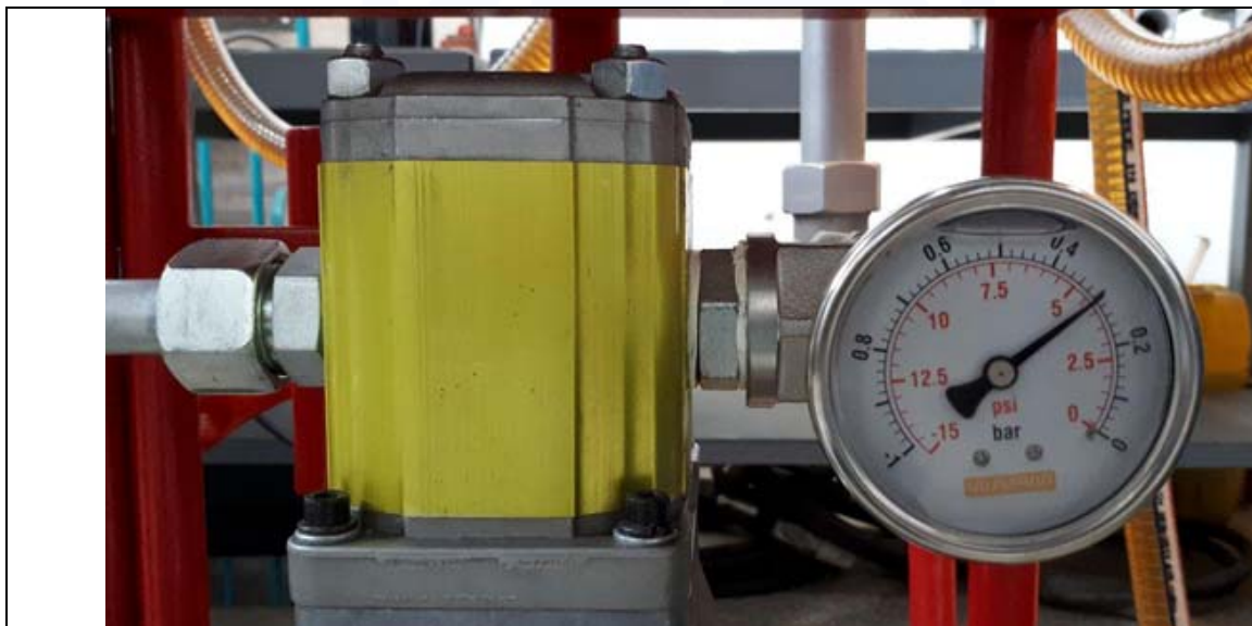
نمایش فشار مکش در ورودی پمپ بر روی گنج خلاء
