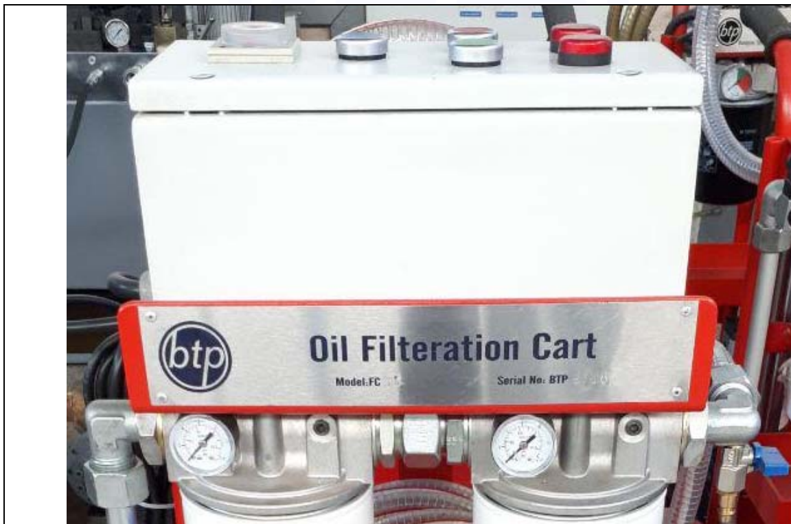
تابلو برق فیلتر کارت مدل SFC - هوشمند
