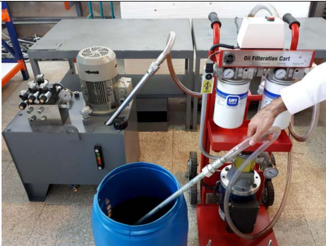
قرار گیری لوله مکش و فشار داخل مخزن و بشکه
