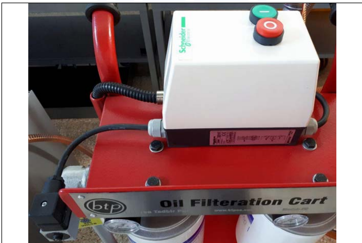
روشن و خاموش نمودن الکتروموتور
