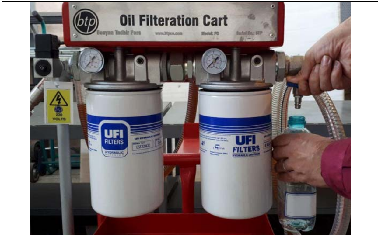
نمونه گیری از روغن
