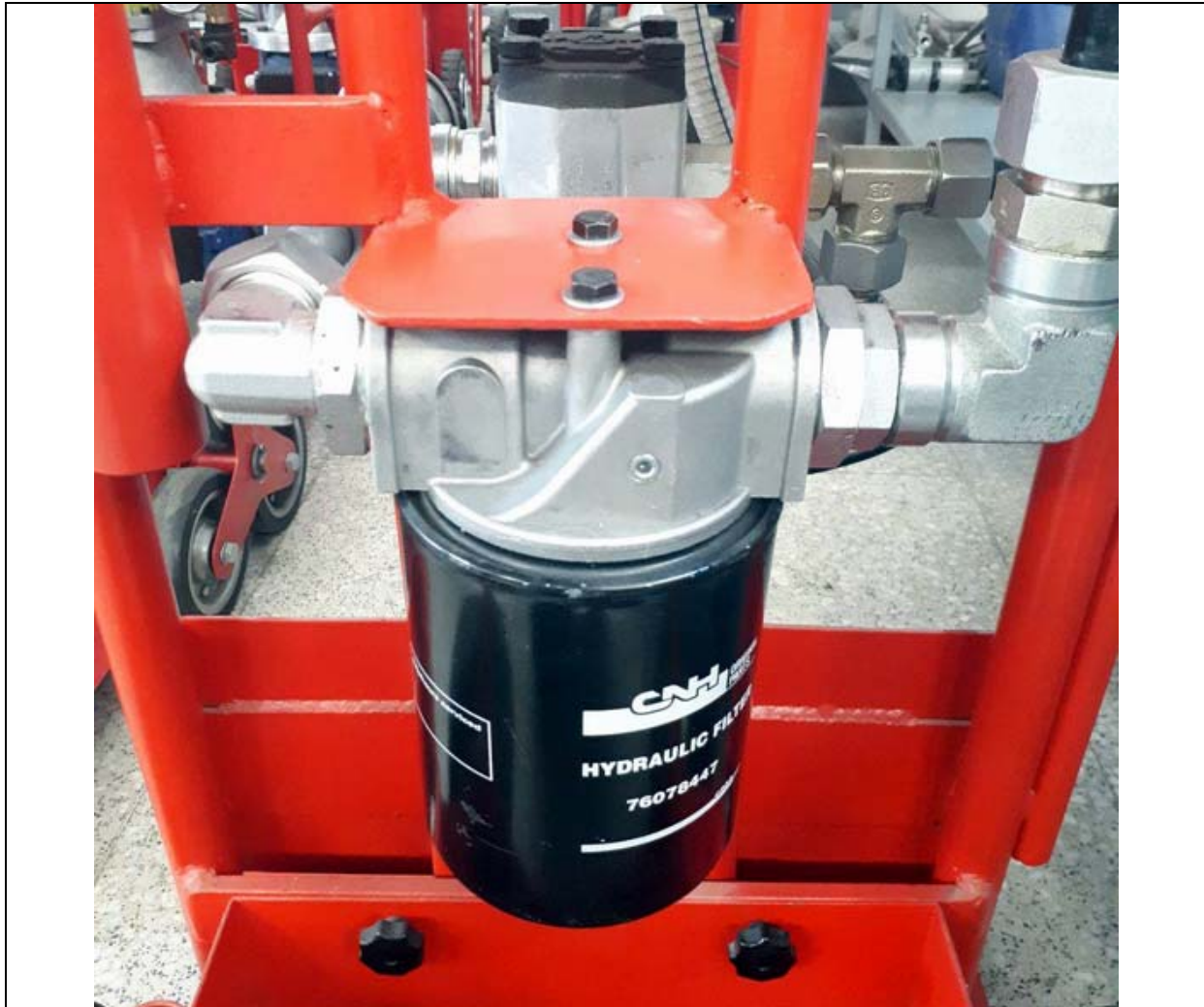
تعویض صافی ورودی پمپ
