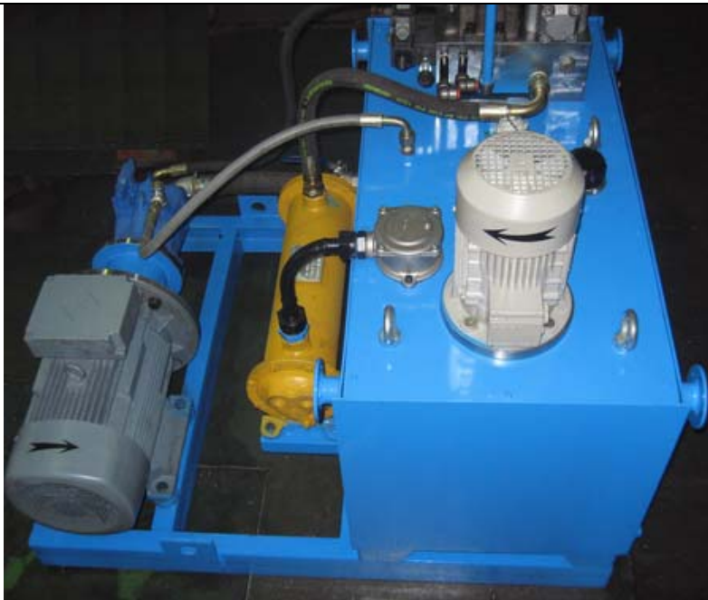
پیش‌بینی قلاب و محل بلند کردن سیستم توسط جرثقیل (یونیت به سفارش شرکت ماشین ساز فرایند)
