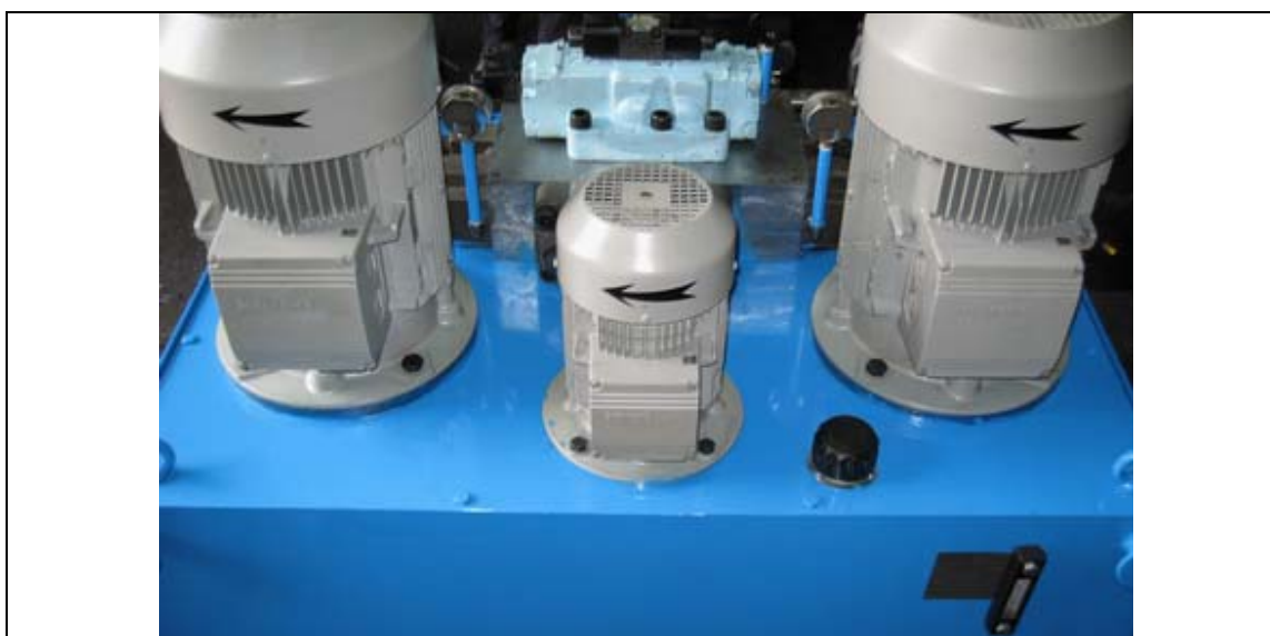
یونیت هیدرولیک شامل چند پمپ برای ایجاد سرعت متغییر (به سفارش شرکت ندا پرداز)
