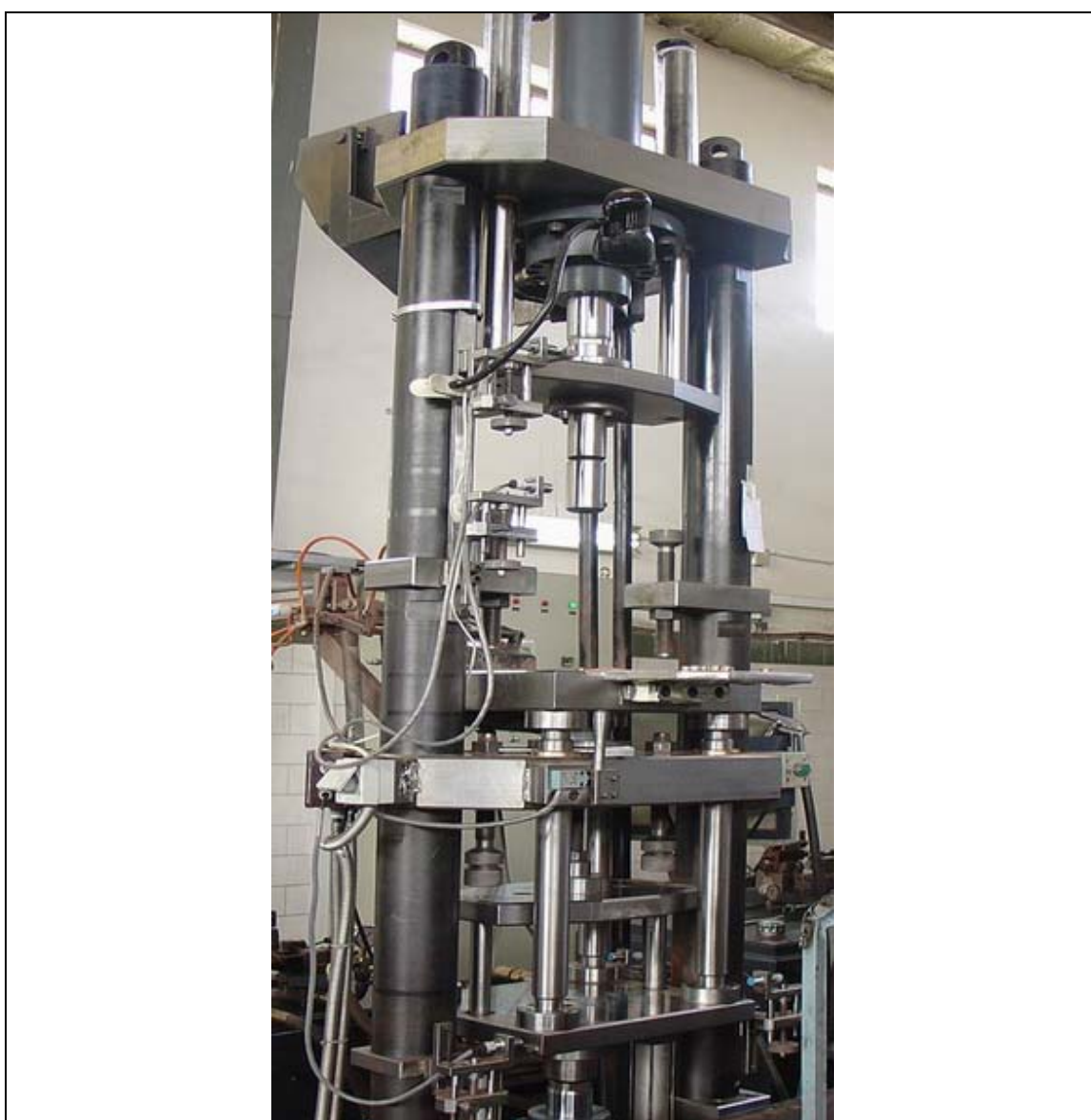
پرس هیدرولیک تولید قطعات متالورژی پودری با کارکرد ۱۲ ساعت در روز (به سفارش شرکت رویان)
