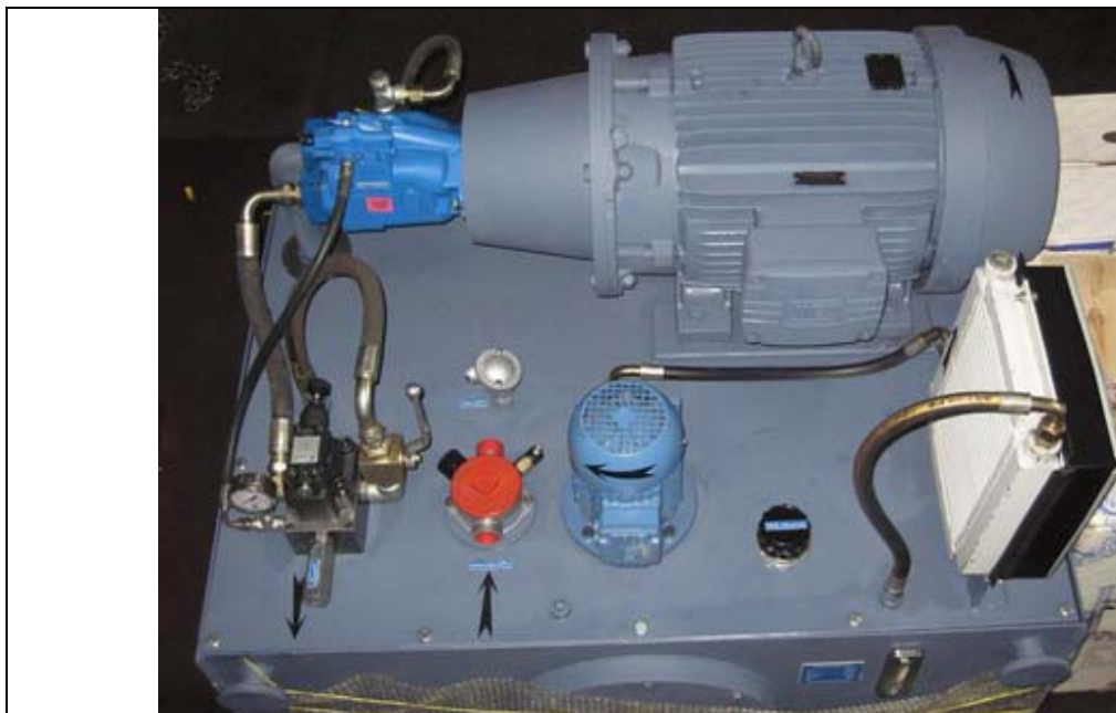
فیلتر برگشت - یونیت هیدرولیک پمپاژ لعاب چینی (به سفارش شرکت گلزار فارس)
