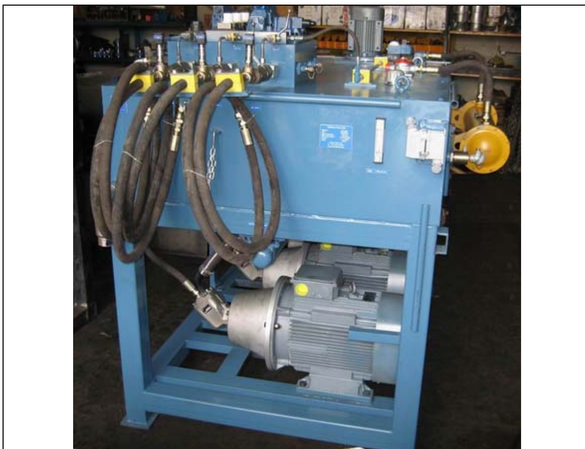
مخزن 1500lit برای دستگاه تست خستگی مخازن CNG (به سفارش شرکت کاوش)
