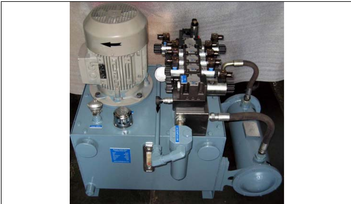
یونیت هیدرولیک کوره ذوب مواد آلیاژی در خلاء (به سفارش شرکت مینا)
