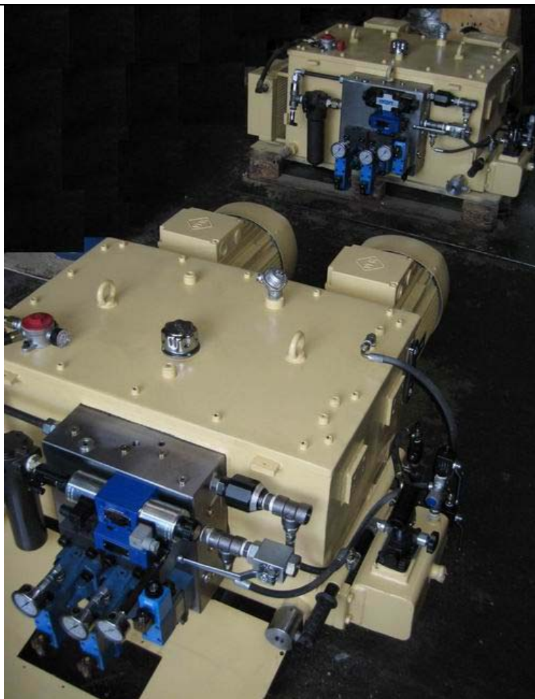
نمونه پروژه ساخت یونیت‌های هیدرولیک سیستم بالابر دقیق با طرح مخزن خاص (بنیان تدبیر پارس)
