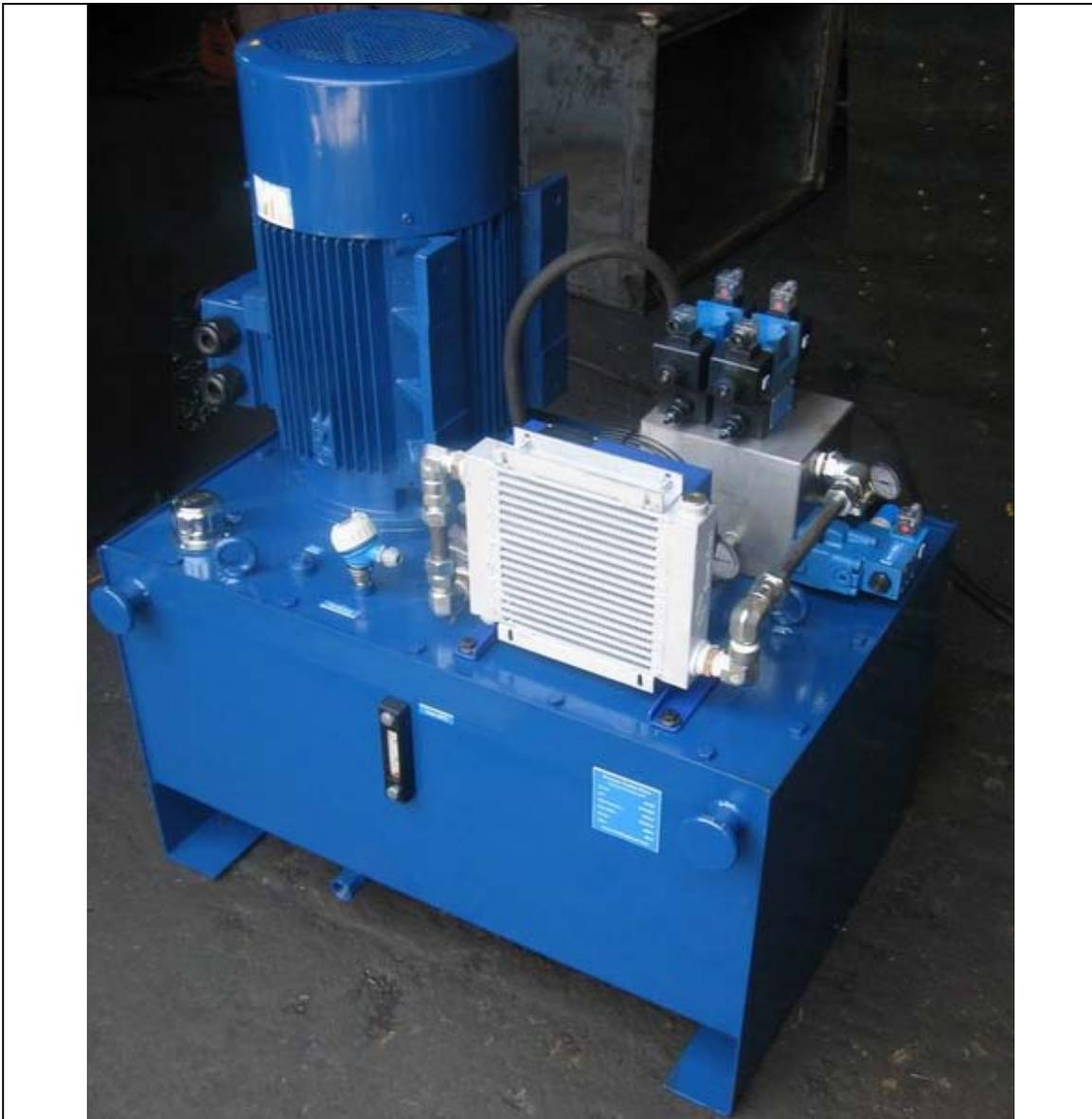
طراحی و ساخت یونیت هیدرولیک تست شلنگ، سیلندر و هیدروموتور با فشار کاری 300bar شامل پمپ پیستونی رادیال، شیرآلات کنترل جهت، فشار و دبی Vickers، خنک کن هوایی، فیلتر خط برگشت Hydroline، شیرهای ربع گرد Rotelmann
